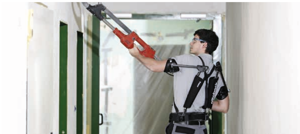
Exoskeletten nemen het gewicht van een specifiek deel van het lichaam weg en verdelen dat over een ander deel
