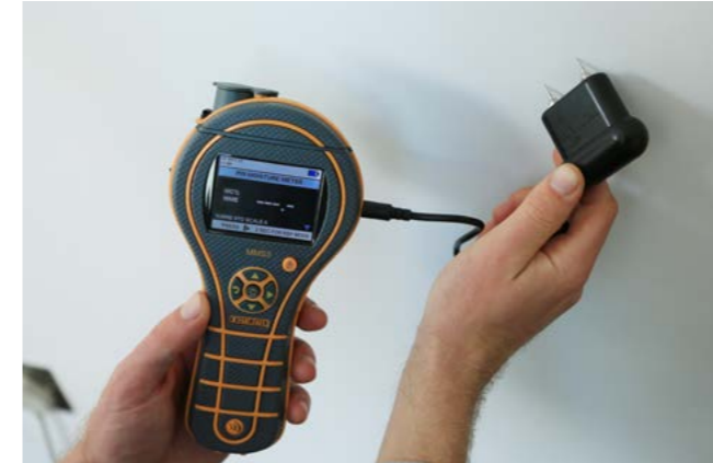
Les humidimètres à broches mesurent le pourcentage d'humidité à l'aide de deux broches de contact
